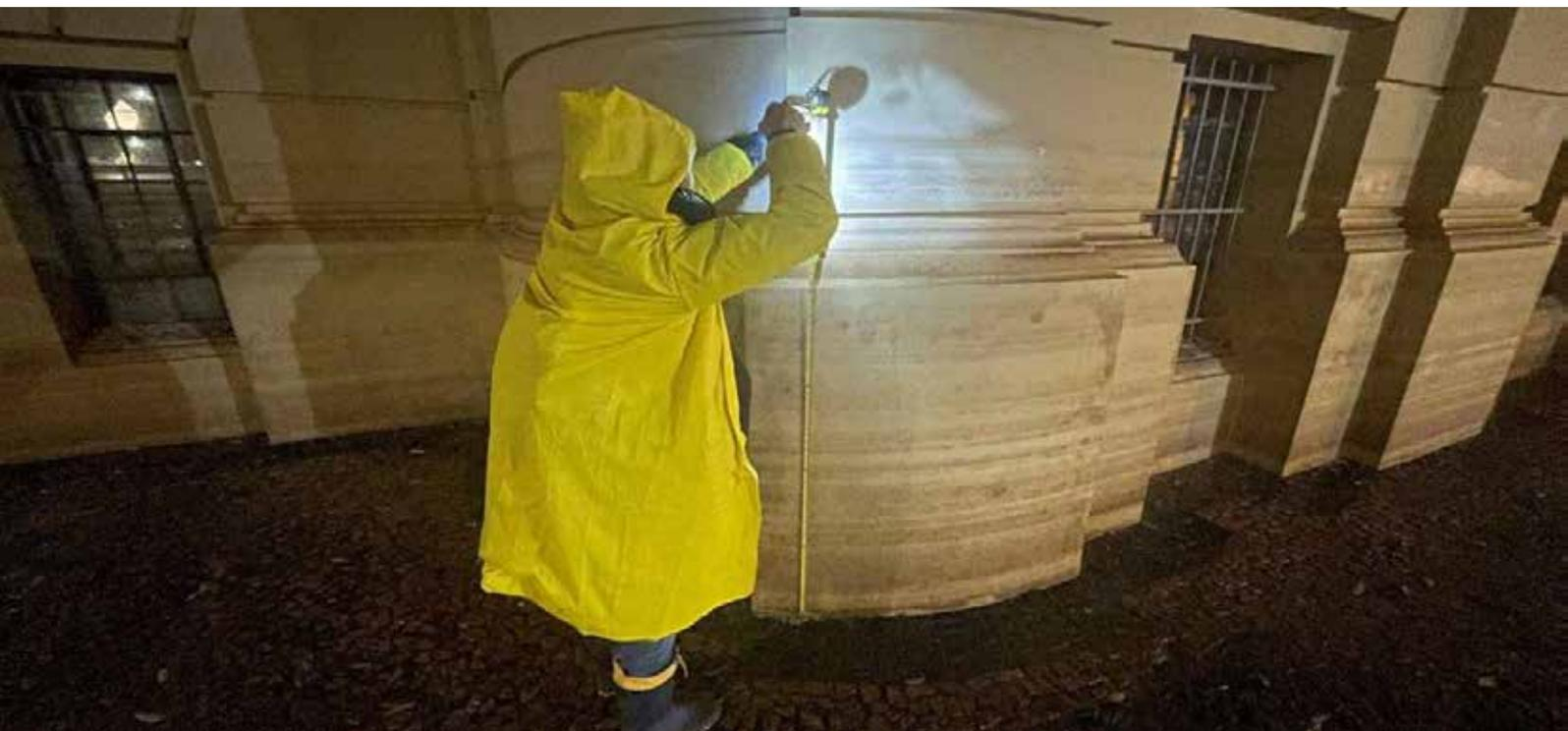
Figura 30: Medições realizadas pela MetSul e seus colaboradores da altura da água alcançada nas paredes de prédios históricos do Centro de Porto Alegre | METSUL
